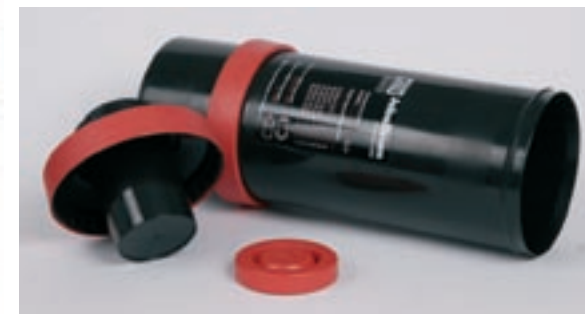
Jobodrum 2840 do obróbki papierów i błon wielkoformatowych. Błona układana jest na wewnętrznej ścianie bębna – utrzymuje się na specjalnych karbach.
