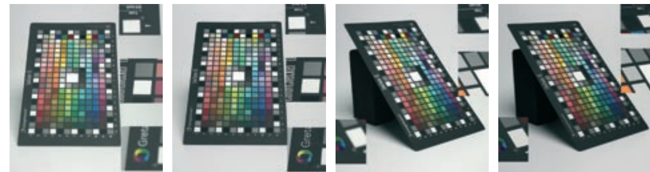
Zdjęcie karty kalibracyjnej, której płaszczyzna jest odchylona pod kątem w stosunku do płaszczyzny materiału zdjęciowego (matrycy), wykonane bez pokłónów standardów. Ostrość ustawiona była na środku karty, przysłona otwarta. Zarówno dół, jak i góra pozostały nieostre.
