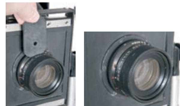
Obiektyw bez migawki Rodenstock APO Ronar 9 × 360 z szufladką na filtry i przysłony Waterhouse. Na pierścieniu przysłon naniesiono dwie ich skale: tradycyjną wyskalowaną aż do wartości 260 oraz drugą, na której wartość przysłony wyrażona jest jako średnica jej otworu w milimetrach. Na zdjęciu obok widoczna przysłona typu Waterhouse.
