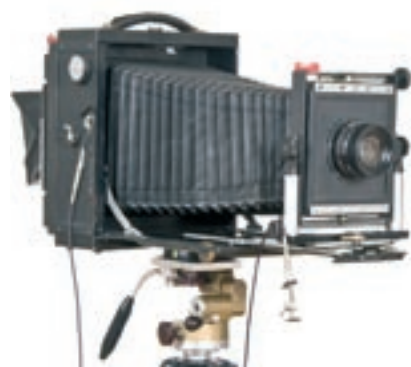
Aparat składany Mentor Studio 13 × 18 cm. Do aparatu został przypięty na normalnej płytce obiektyw bez migawki Rodenstock APO-Ronar 360 mm (ekwiwalent 70 mm). Miech wysunięty na podwójnym wyciągu.
