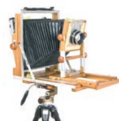
Przy odrobinie zdolności manualnych można pokusić się o samodzielne zbudowanie aparatu wielkoformatowego. Na zdjęciu aparat autora wykonany z drewna teakowego i kształtowników aluminiowych. Wykorzystano w nim gotowy miech, ramkę do kaset i matówkę od aparatu Mentor Panorama 18 × 24 cm. W aparacie znajduje się obiektyw typu „convertible” Schneider Symmar 240 mm (ekwiwalent 35 mm).
