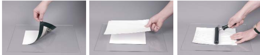
Suszenie na szybie. Układamy wy- Przykrywamy mokrą odbitkę kartką papieru i mocno, lecz ostrożnie wałku- plukaną odbitkę obrazem do tafli. jemy „od siebie” przytrzymując ją palcami drugiej ręki.
