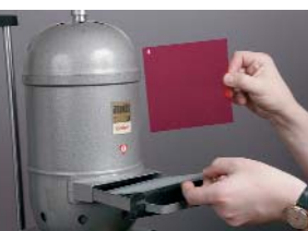
Głowice „czarno-białe” niektórych powiększalników posiadają szufladki, w które możemy wkładać matowe płytki rozpraszające oraz filtry Multigrade.
