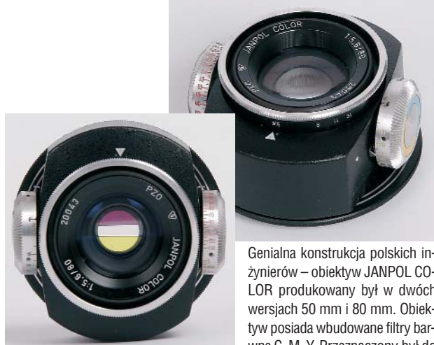
Genialna konstrukcja polskich inżynierów – obiektyw JANPOL COLOR produkowany był w dwóch wersjach 50 mm i 80 mm. Obiektyw posiada wbudowane filtry barwne C, M, Y. Przeznaczony był do wykonywania powiększeń barwnych. Teraz można wykonywać przy jego użyciu powiększenia na papierach wielogradacyjnych. Należy jednak pamiętać o tym, że gdy używamy filtrów, przysłona musi być całkowicie otwarta.
