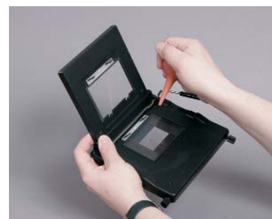
Korzystając z ramek z szybkami musimy usunąć ewentualne drobiny kurzu (przy użyciu gumowej gruszki) przed umieszczeniem w nich negatywu.
