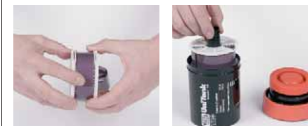
Obracając na przemian względem siebie dwoma częściami szpuli wsuwamy do niej błonę.
