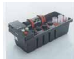
Procesory JOBO do obróbki błon ułatwiają utrzymanie stałej temperatury roztworów roboczych oraz procesu podczas trwania obróbki chemicznej. Zapewniają również równomierne mieszanie poprzez obrót koreksu wokół jego osi. Na zdjęciu produkowany nadal procesor JOBO CPE-2 plus.
