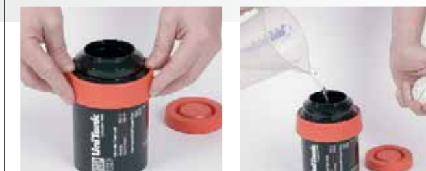
Zakładamy lub zakręcamy pokrywę koreksu i wlewamy roztwór wywoływacza. Staramy się zrobić to jak najszybciej i uruchamiamy stoper.
