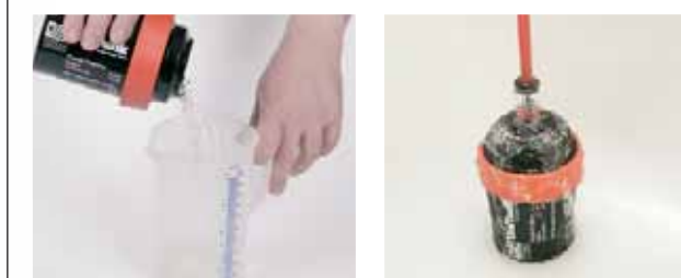
Po zakończeniu każdej z kąpeli staramy się jak najszybciej opróżnić koreks z roztworu roboczego. Intensywność procesu płukania możemy podnieść poprzez zastosowanie urządzenia zwanego kaskadą (specjalna rurka, której jeden koniec zakładamy na wylot kranu, a drugi umieszczamy w kanale wlotowym koreksu) tworzącego mieszaninę wody i pęcherzów powietrza. Ten sposób płukania skraca czas jego trwania do 5-10 minut i pozwala zaoszczędzić spore ilości wody.
