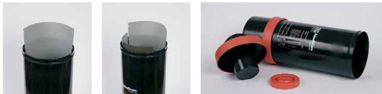
Tank JOBBO systemu 2800 do obróbki błon arkuszowych i papierów nie posiada rdzenia, na który wsuwa się szpule. W pokrywie znajduje się specjalny kubeczek do którego wlewamy roztwory robocze. Po przewróceniu tanku na bok roztwór wylewa się do wnętrza tanku. Błony umieszcza się na ściankach tanku – w ich utrzymaniu pomagają specjalne karby.
