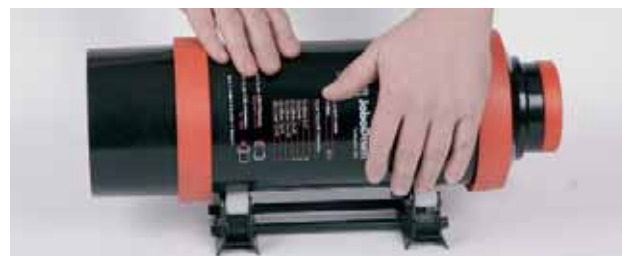
Tank do obróbki błon arkuszowych obracamy na specjalnym urządzeniu z rolkami lub toczymy po blacie stołu.
